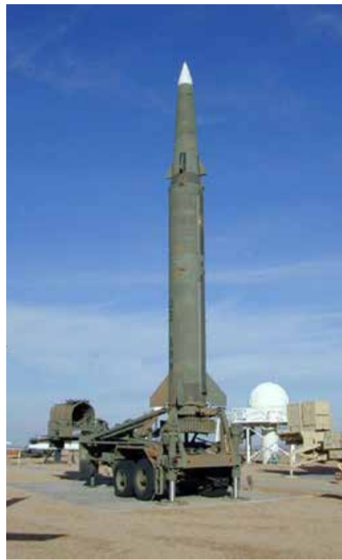
Твердотопливная двухступенчатая баллистическая ракета Першинг-2 средней дальности
